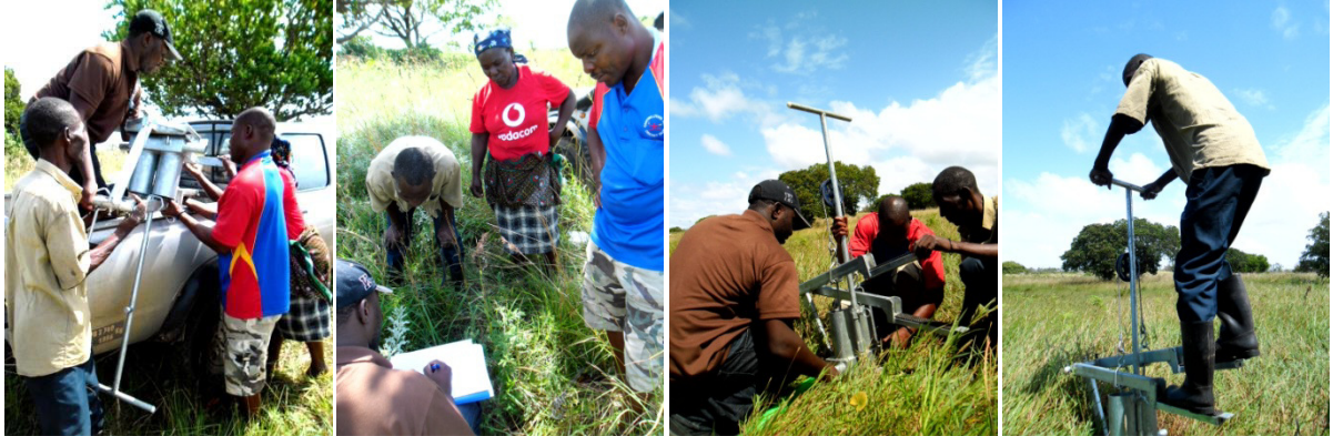
Imagens 38, 39, 40 e 41 – (Da esquerda para a direita) Entrega da bomba pedestral na Associação da Ponta de Ouro (27 de Março): Descarregando a bomba; Esquematizando o campo para posicionamento da bomba com o técnico de irrigação do fornecedor iDE, Eng o Lionel Zsinsengwe; Montagem da bomba; Teste.
