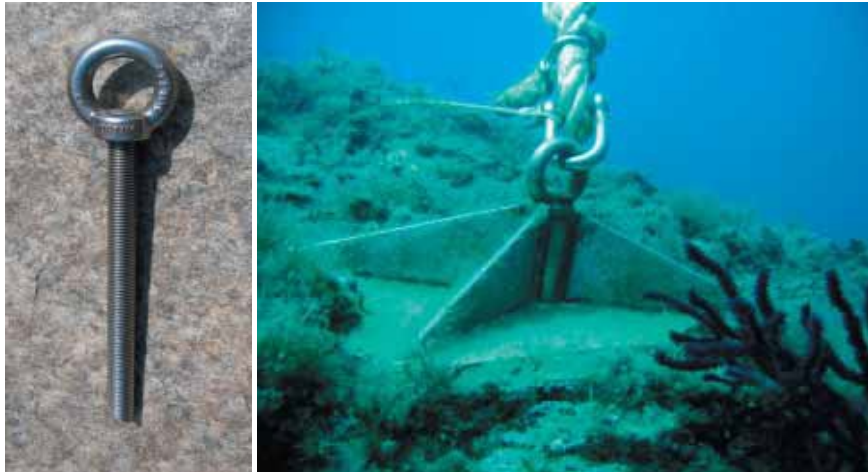
Figure 8 : Les scellements d'ancrages (Francour et al. , 2006)
