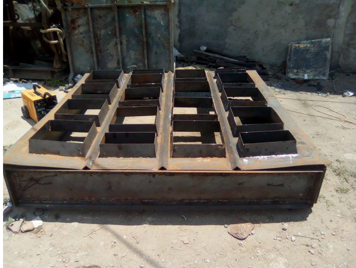
Figure 18 : Le moule du corps mort
