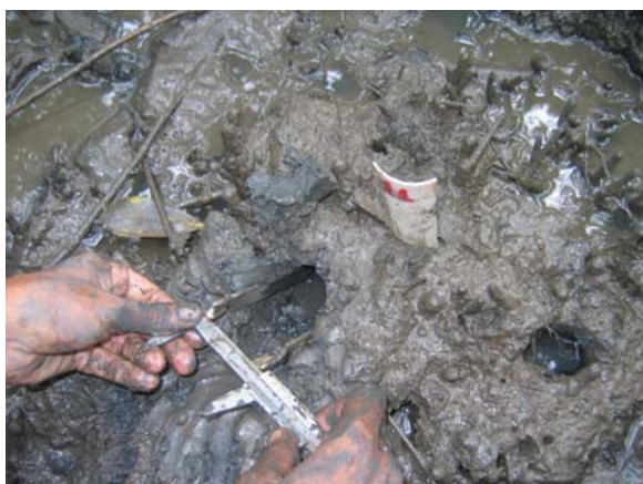
Figura 22 – Medição de abertura de galeria com paquímetro com espátulas adaptadas.
